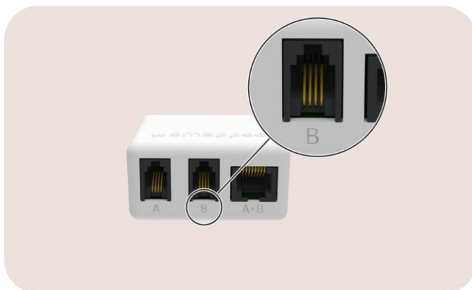
Abbildung 20: Blick auf den B-Anschluss des Smappee-Splitters
