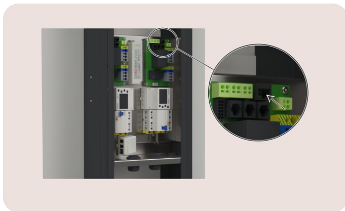
Afbeelding12: aanzicht op de A+B-poort van het relaisbord
