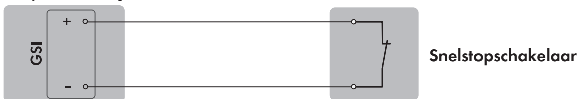
Afbeelding 12: Aansluiting van een schakelaar voor de snelstop op de digitale ingang GSI van de Sunny Boy Smart Energy die als System Manager moet worden geconfigureerd
