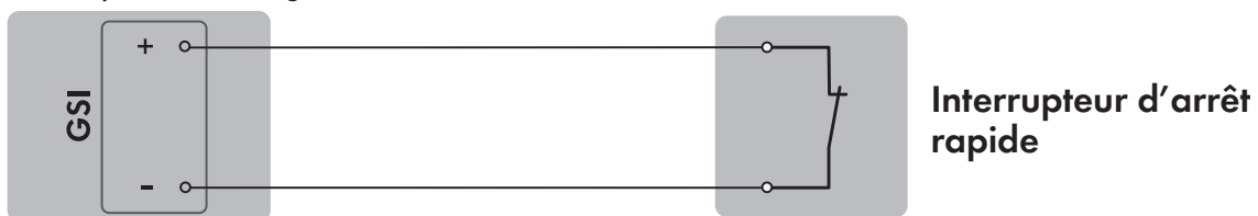
Figure 12 : Raccordement d'un interrupteur d'arrêt rapide à l'entrée numérique GSI du Sunny Boy Smart Energy qui doit être configuré comme System Manager
